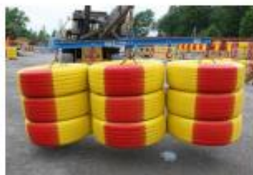
Lyftok måste användas vid transporter.
